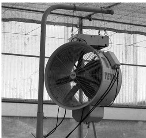
Figura 136. Pulverizador centrífugo-neumático de chorro transportado
