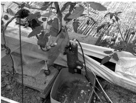
Figura 116. Sensores de pH y CE utilizados para el control de la fertirrigación en invernaderos
