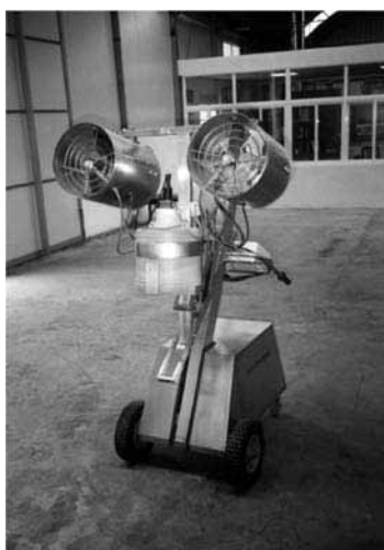
Figura 142. Pulverizador hidroneumático desplazable manualmente
