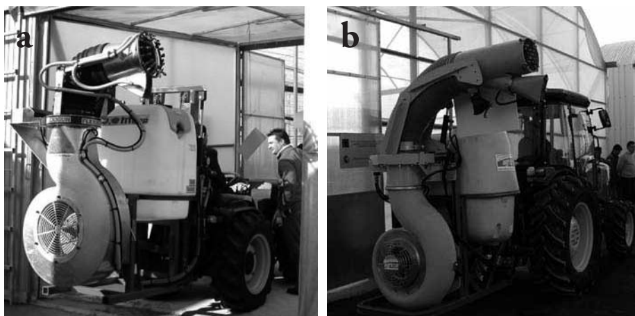
Figura 139. Pulverizadores hidro-neumáticos suspendidos al tractor
