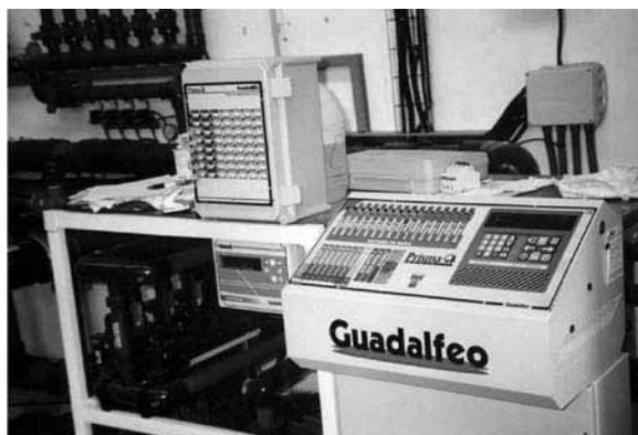
Figura 114. Equipo electrónico de un controlador automático de fertirrigación con el cuadro de mando, donde se indican los sistemas en funcionamiento por medio de luces
