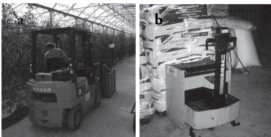
Figura 120. Carretilla elevadora (a) y transpaleta (b) utilizadas para labores de carga y transporte dentro de invernaderos y semilleros
