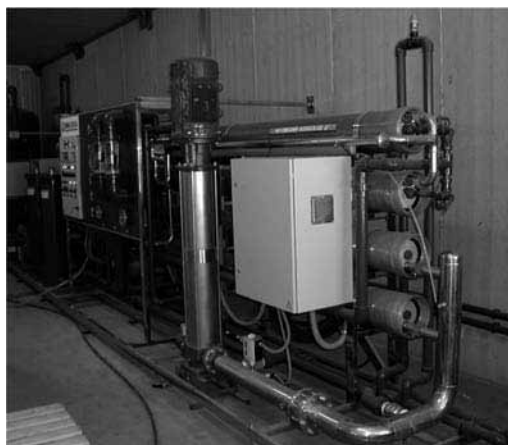
Figura 117. Equipo de desalinización de agua procedente de pozos para su uso en el riego del invernadero
