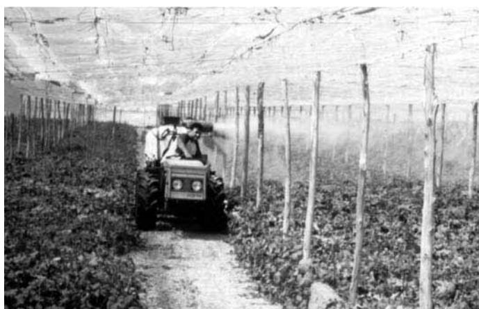
Figura 140. Pulverizador hidro-neumático realizando un tratamiento
