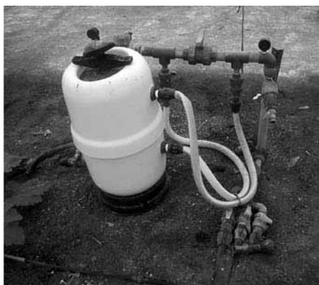
Figura 108. Tanque de abonado conectado en paralelo a la red de riego
