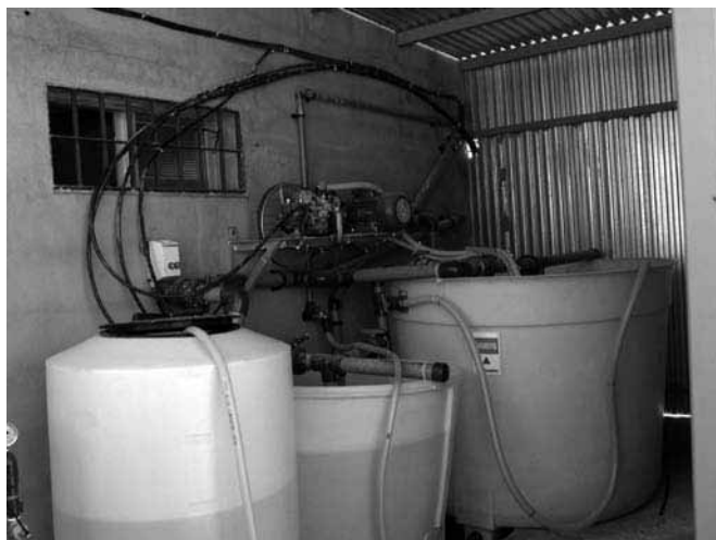
Figura 125. Depósitos para la realización de tratamientos fitosanitarios con sistema de agitado por chorro de agua
