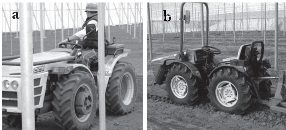
Figura 118. Tractores articulados con tracción a las cuatro ruedas utilizados en invernaderos para la preparación del suelo enarenado (a) y para su mantenimiento mediante roturación (b)
