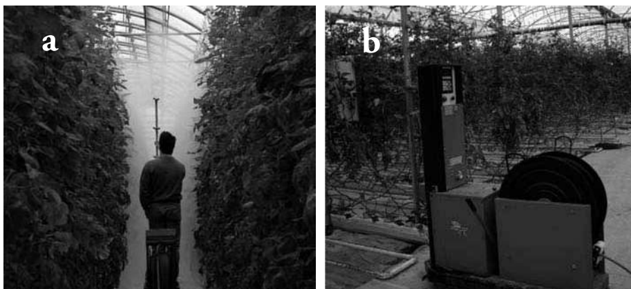
Figura 132. Carros autopropulsados eléctricamente con barras verticales de tratamiento: con control por operario, demostración aplicando solo agua (a), y automático (b)
