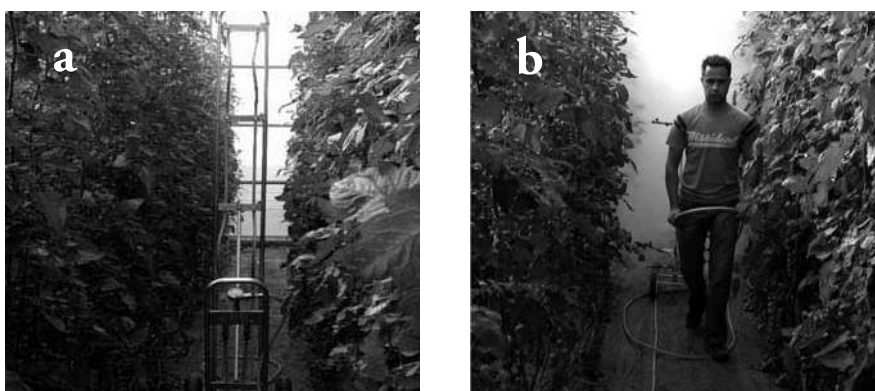
Figura 131. Barra vertical sobre carro (a), y demostración de su accionamiento manual aplicando sólo agua (b)
