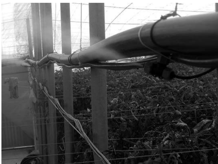
Figura 134. Chorro de aire y gotas de tratamiento generado por una boquilla de nebulización
