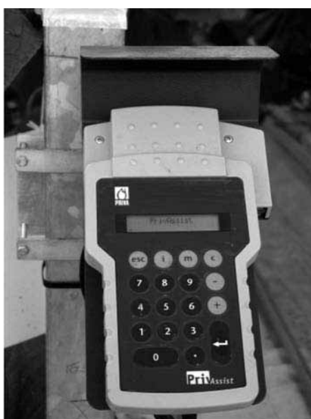
Figura 124. Sistema de almacenamiento de datos electrónicos utilizado para el control de tiempos de las labores culturales en los invernaderos
