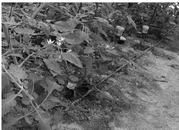
Figura 115. Tensiómetros utilizados para el control del riego en invernaderos
