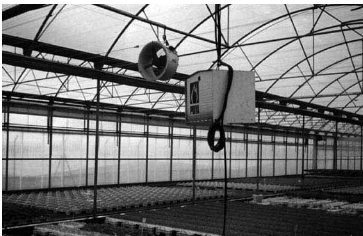
Figura 104. Caja de medida con sensor de la concentración de CO 2
