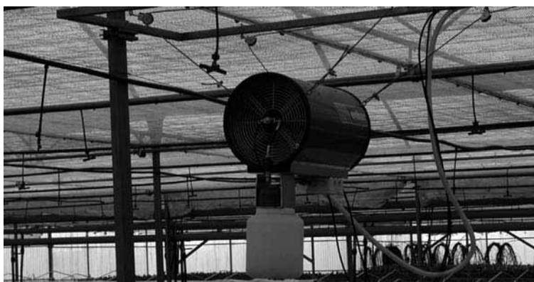
Figura 135. Pulverizador hidroneumático de chorro transportado estático de ultra-bajo volumen
