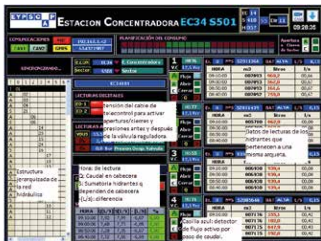
Captura del Aplicativo de Gestión del Sistema de Telecontrol en la CUCN – Comarca de Níjar – Almería
